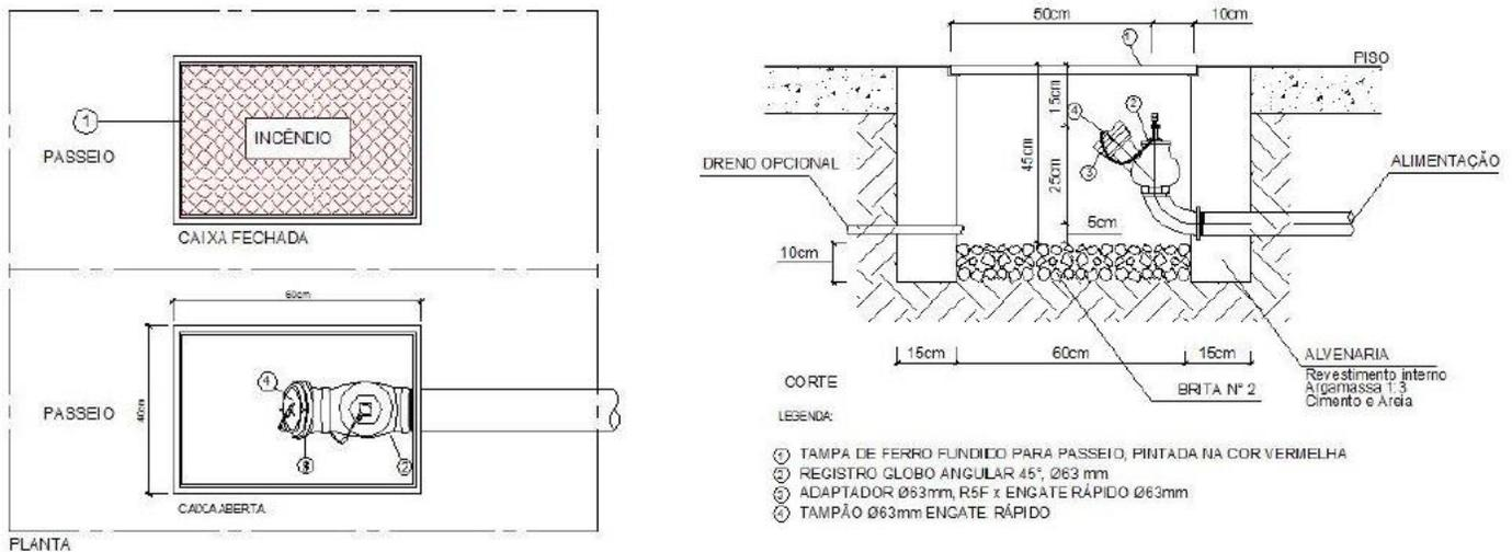
Se houver necessidade os hidrantes externos (dispositivos de recalque) devem ser construídos no passeio em frente da fachada da edificação e obedecer a IT-23 do CBMMG.
