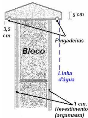
O chapéu de muro ou cimalha em concreto com pingadeira devem atender à diversas medidas de espessura dos muros projetados.
