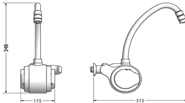
Torneira branca, termoplástica, potência na faixa de 4.800 / 5.500 W, bica móvel com arejador, 3 temperaturas (quente, morna e fria), com tolerância de mais ou menos 5%, resistência de liga especial e contato de prata.
