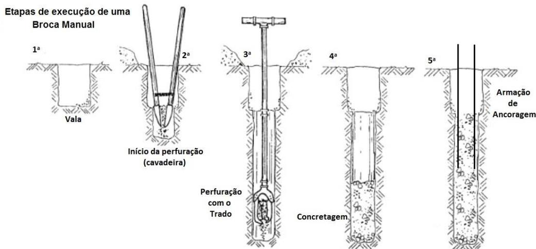
São estacas moldadas "in loco", executadas sem revestimento, de modo a transmitir para camadas mais resistentes do solo, as cargas a que serão submetidas.
