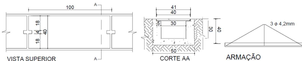
Para a construção da canaleta, o terreno de fundação deverá ser regularizado e apoiado manualmente.
