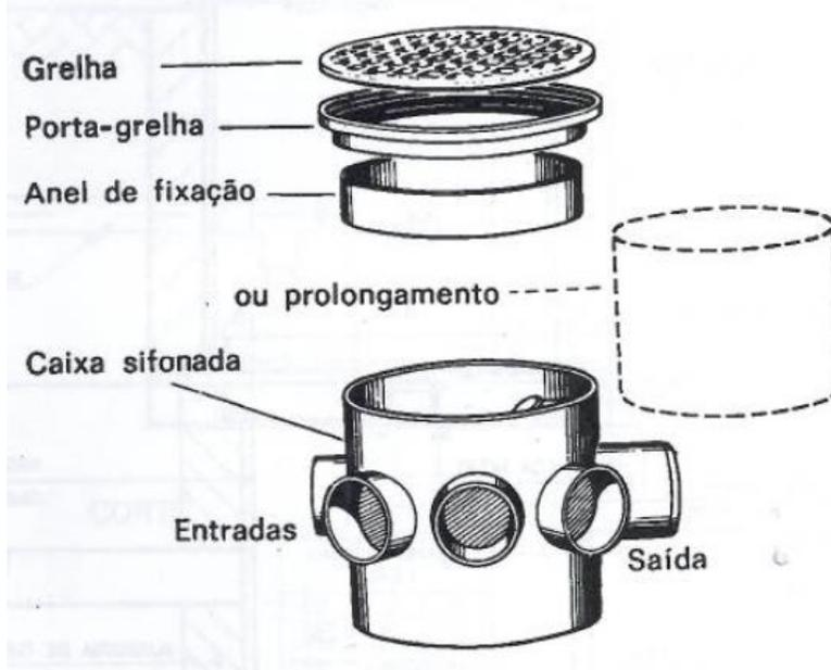
É a peça da instalação de esgotos que recebe as águas servidas de lavatórios, banheiras, box, tanques e pias, ao mesmo tempo em que impede o retorno dos gases contidos nos esgotos para os ambientes internos dos compartimentos.
