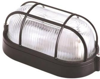
Para iluminação externa, em parede, quando não indicadas no projeto de arquitetura, deverão ser utilizadas luminárias de sobrepor tipo "tartaruga", com corpo e grade basculante de alumínio fundido, refrator de vidro prismático, com porta-lâmpada não energizado E-27, com entradas rosqueadas de  $\frac{3}{4}$ ", na cor preta, outras cores somente se aprovados pela fiscalização.
