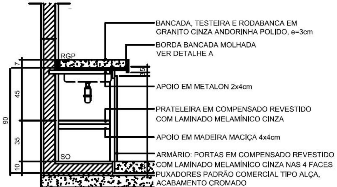
Conjunto de bancada de laboratório com tampo de granito cinza andorinha l=60cm e c=265cm, testeira de 5cm, rodabanca de granito cinza andorinha h= 10 cm, base em alvenaria h=10cm, armário em compensado 20mm com portas revestida em laminado melamínico branco nas duas faces h=75cm, puxadores de metal cromado, prateleiras do mesmo material das portas, cuba de aço inox AISI 304 465 x 330 mm completa com torneira e acessórios.
