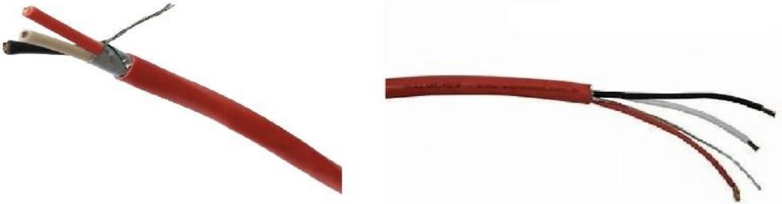
Cabo de cobre, com 2 condutores em cobre nú de têmpera mole, com diâmetro nominal de  $3 \times 1,5 \text{ mm}^2$  ou  $4 \times 1,5 \text{ mm}^2$ , encordoamento classe 4; isolamento termoplástico para têmpera mole VC / E  $105^\circ\text{C}$ , nível de isolamento de 600 V, para o sistema de detecção de incêndio.
