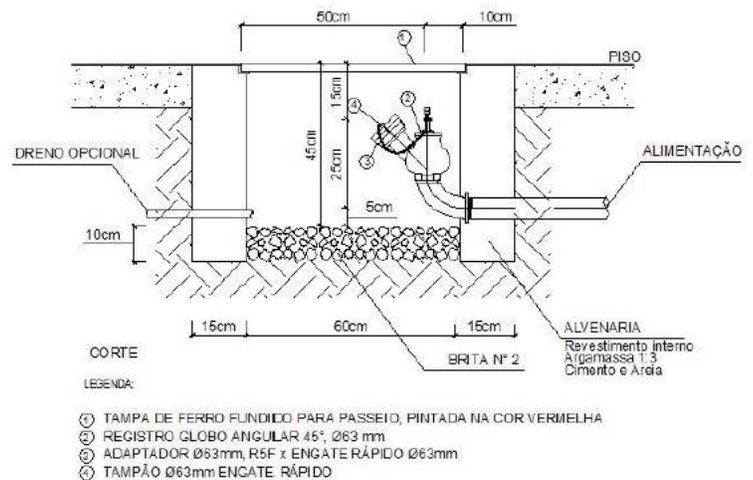
Se houver necessidade os hidrantes externos (dispositivos de recalque) devem ser construídos no passeio em frente da fachada da edificação e obedecer a IT-23 do CBMMG.
