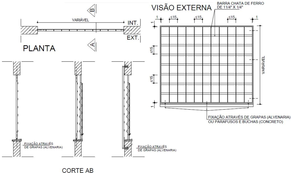
A grade de proteção, para janelas e basculantes, será constituída por: grade confeccionada com barras chatas de 1 1/4" x 1/4", dispostas horizontalmente, verticalmente e no requadro externo da peça, em aço SAE 1010 / 1020; grapas em chapa de aço de 1" x 1/8", ou parafuso galvanizado e bucha de nylon nº 8, para a fixação do conjunto.
