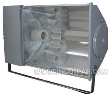
Projektor fechado em corpo refletor de alto brilho, laterais em chapa de aço pintado em epóxi, com lente plana de cristal temperado e suporte de fixação em aço galvanizado.
