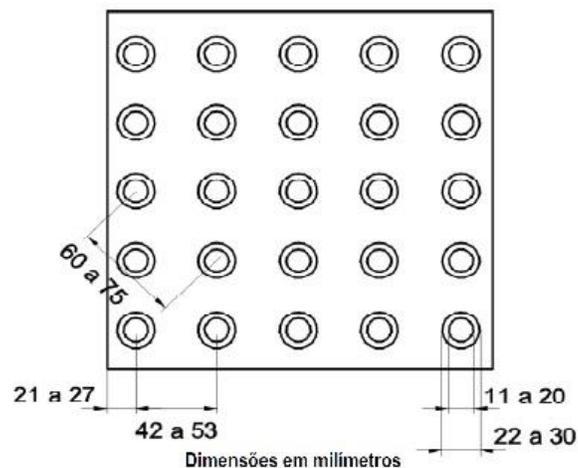
A forma do piso alerta se constitui em troncos - cônicos compostos na superfície plana.
